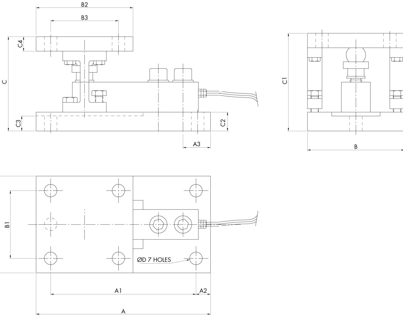
**ACCIAIO ZINCATO PASSIVATO (portata, dimensioni e carico massimo per singolo modello)**
