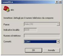
4. Impostare i parametri di comunicazione della porta. Baud rate (Bit per secondo) e Data format (Bit di dati, Parità, Bit di stop) devono corrispondere a quelli impostati nel DAT (vedi menu SERIAL a pagina 28) Selezionare la voce "Controllo di Flusso" = Nessuno. Cliccare su "Applica", quindi su "OK".
