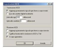
6. Nella parte superiore (Trasmissione ASCII): Abilitare "Aggiungi avanzamento riga ad ogni ritorno a capo inviato" Impostare "Intervallo riga" a 200 millisecondi Nella parte inferiore (Ricezione ASCII): Abilitare "A capo automatico" Al termine cliccare su OK (due volte)
